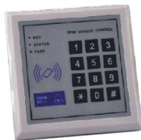
La tastiera a codici **DIGITAL KEYPAD** è dotata di contatto tamper antifurto, possibilità di inserimento di 250 codici separati, di 01 codice comune e azionamento con carta "Badge" da 125 Khz, pulsante campana con contatto pulito per avvisatore sonoro.
